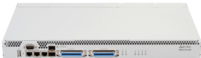
**Платформа SMG-1016M** может использоваться в качестве транкового шлюза для сопряжения сигнальных и медиапотоков TDM- и VoIP-сетей, IP-АТС с поддержкой функций ДВО и СОРМ, а также выступать универсальным решением для построения инфокоммуникационных сетей связи нового поколения. Широкая функциональность, строгое соответствие стандартам и высокая надёжность операторского класса позволяют решать на базе SMG-1016M большинство возникающих у операторов и сервис-провайдеров задач.
